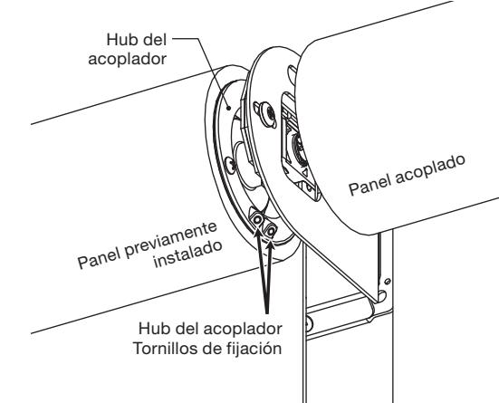
**PRECAUCIÓN:** RIESGO DE CAÍDA DE OBJETOS. Los tornillos de fijación del cubo del acoplador son apretados en la fábrica con un par de apriete de 0,7 N·m (6,0 pulg-lbs). El hecho de no volver a apretar los tornillos de fijación del hub del acoplador a un par de 0,7 N·m (6,0 pulg-lbs) podría dar lugar a lesiones leves a moderadas.
